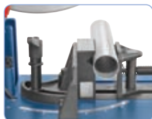
Sisältää V-ura leuat putkien kiinnitykseen
