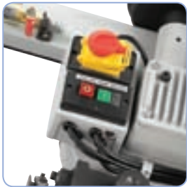
Selkeästi sijoitetut käyttökytkimet sahakaareissa
