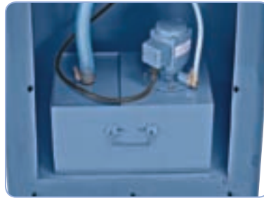
Tehokas jäähdytyslaitte integroitu jalustaan, siten vaatii vähän tilaa
