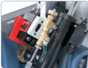
Kuulalaakeroituidut teränsämitat ja lastuharja ideaaliin sahaustuloksiin
