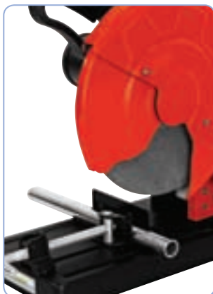
Mukana myös kääntyvä työkappaleenkiinnitin +30° - -45°
