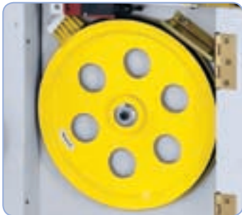
Dynaamisesti tasapainoitettujen valurautavannepöyrien takaavat sujuvan sahauksen
