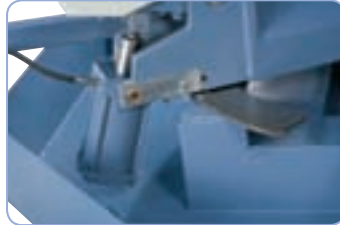
Hydraulisylinteri kiristää sahakaarta mukautettuun shaukseen
