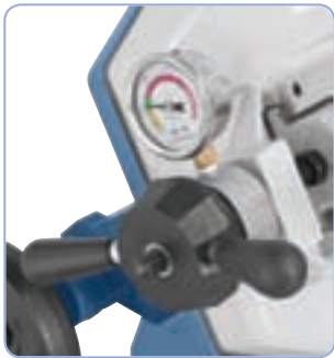
Teränsäätömittari mahdollistaa optimaalisen teränsäädön (vakiona)
