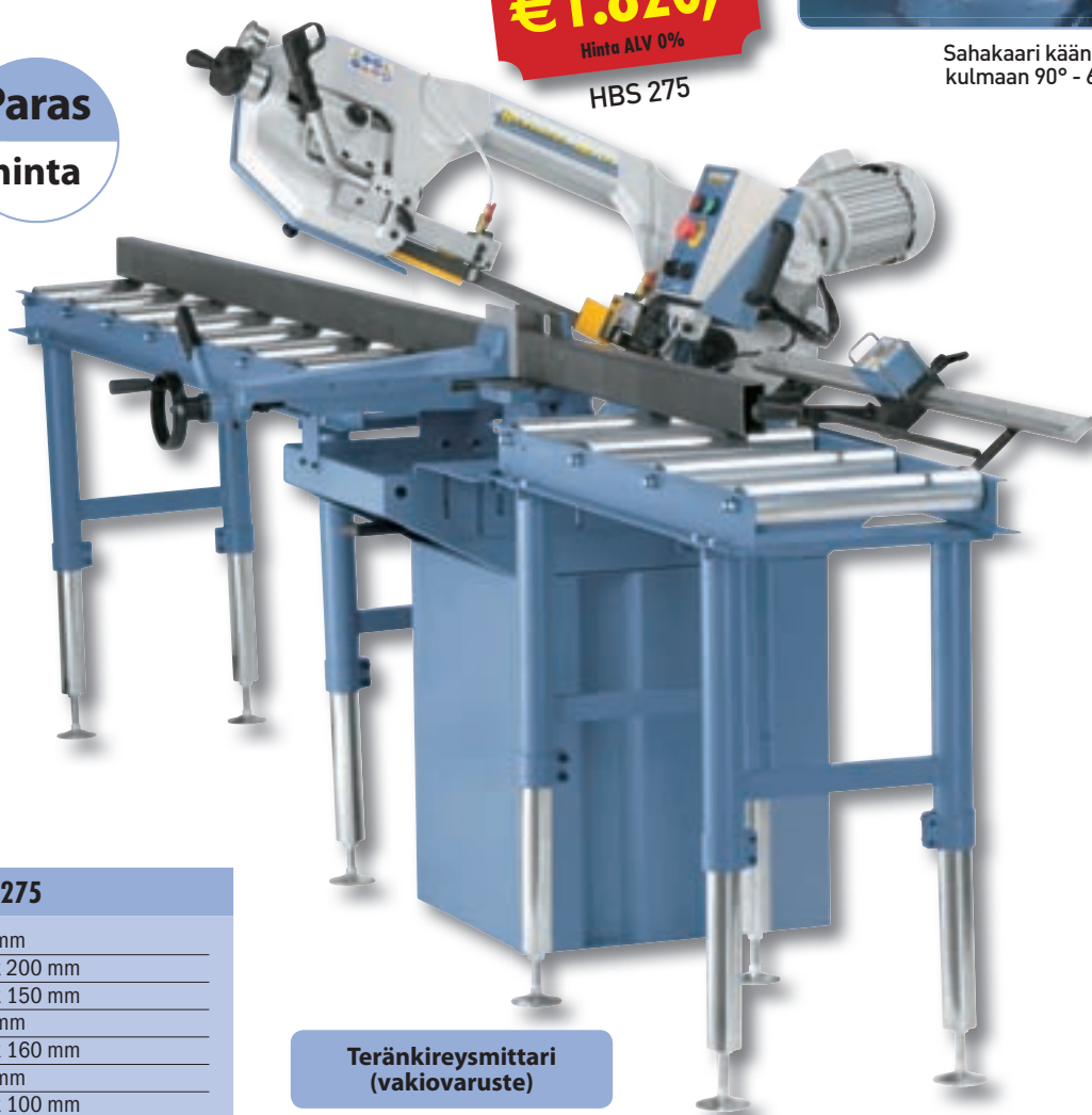
Vakiovarusteena teränkireysmittari optimaaliseen teränsäätöön
