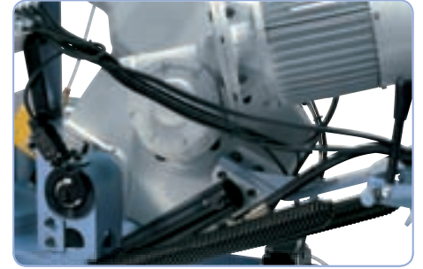
Kiristysjousella säätö manuaaliseen sahakaaren syöttöä varten
