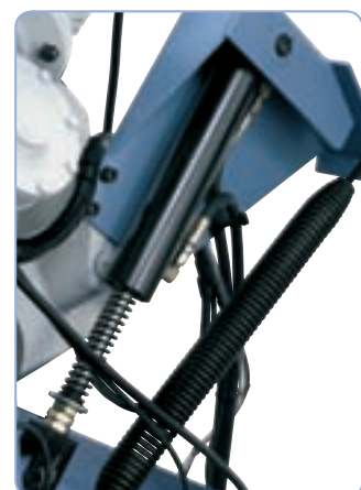
Vakiovarusteena hydraulisynteri tarkkaan sahakaaren laskuun
