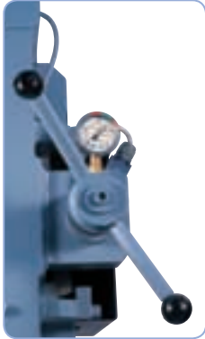
Painemittarilla tarkka terätkireyden säätö
