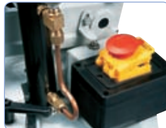
Vakiona automaattinen sammutus sahausksen loputtua, on/off kytkin IP 54
