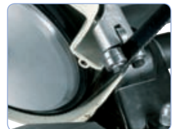
Laadukaat kumipäällysteiset vannepyörät takaavat pehmeän käytön
