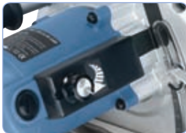
MHK 200:ssa on portaaton nopeudensäätö
