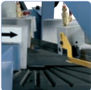
Teräohjaimet laakeroitu ja nopeasti säädettävissä, jäähdytyslaitte takaa parhaan mahdollisen tuloksen
