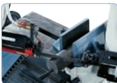
Kappaleen pikakiinnitys materiaaliavasteella
