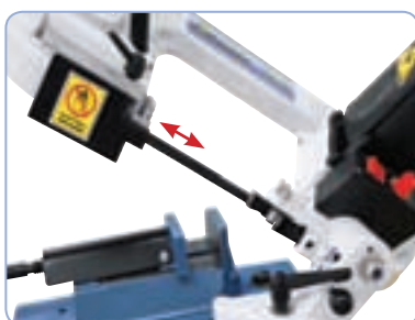
Teränohjaimet voidaan säätää eri materiaaleille sopivaksi
