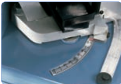
Säädettävä sahakaari kulmaansahausta varten
