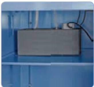
Jäähdyttilaite sijaitsee koneen jalustassa
