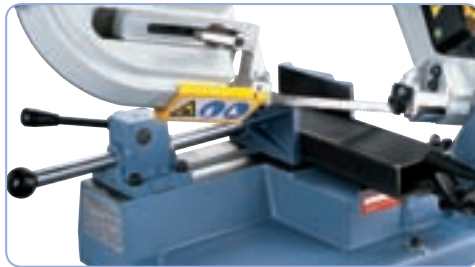
Kappaleen pikakiinnitys ja materiaalivaste vakiona
