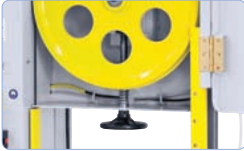
Käsiopöytä mahdollistaa tarkan teränsäädön
