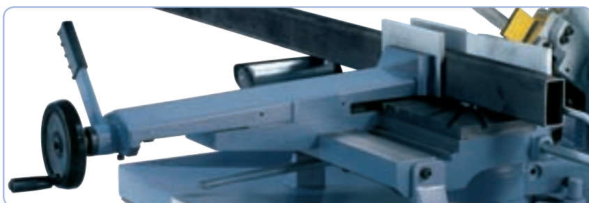
Iso ruuvipuristin pikakiinnityksellä, ja mittavasteella
