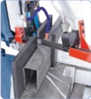
Pikakappaleenkiinnitys, voidaan säätää kulmaan sahausta varten
