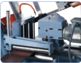
Kappaleenkiinnitys laitteen mukana tulee motorisoidut rullat, työkappaleen syöttämistä varten
