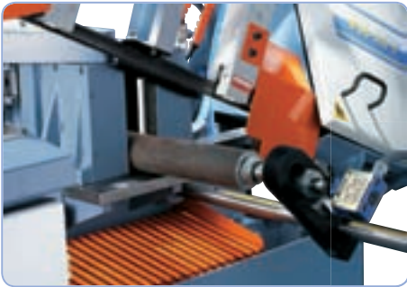
Kappalevaste automaattisella rullasyötön sammutuksella vakiona
