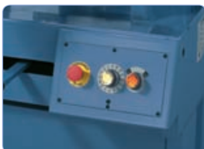
Sahakaaren laskua voidaan säätää säätöventtiilin avulla
