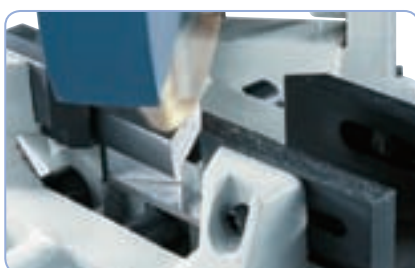
Sahausyksikkö kääntyy 60° vasemmalle/oikealle kulmaansahausta varten
