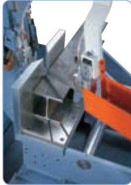
Teränohjaimissa pikasäätö leveille työkappaleille takaa hyvän työn jäljen
