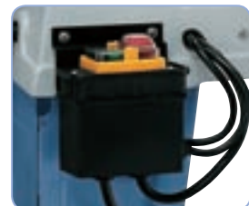
Suojakytin alijännitesuojalla ja automaattinen sammutus sahauksen loputtua
