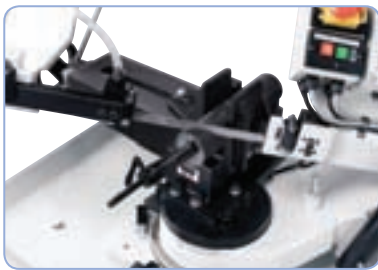
Sahakaari kääntyy kulmaan 90^\circ - 45^\circ
