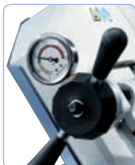
Vakiovarusteena teränkireysmittari optimaaliseen teränsäätöön
