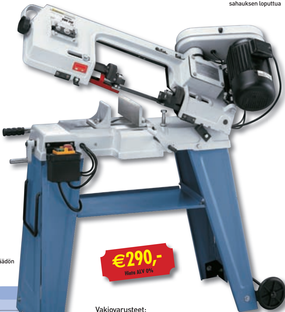
Suojakytin alijännitesuojalla ja automaattinen sammutus sahauksen loputtua
