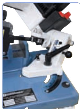
Lukittava sahakaari mahdollistaa koneen kätevän kuljetuksen
