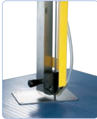
Kuulalaakeroidut teränohjaimet, säädettävissä erikokoisille työkappaleille
