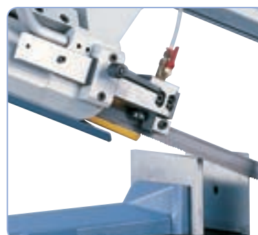
Teränohjaimet pikasäädöllä ja kuulalaaakereilla varustetut, optimaalinen nopeaa ja tarkkaa sahausta varten
